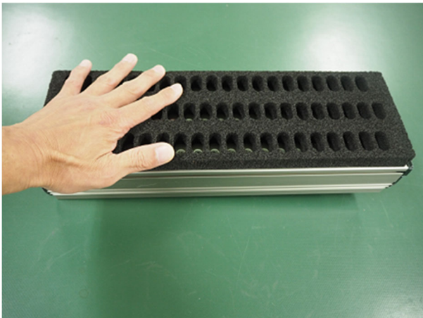
【手でスポンジを押し付けて貼り付けする】
