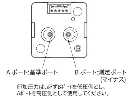
印加圧力は、必ずB\* -トを低圧側とし、A\* -トを高圧側として使用して下さい。
