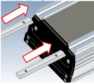
2. 側面から入れた長ナットを中央付近へ置き、 M6\*20六角穴付ボルトでブラケットを仮組みします。 その後、接続プレートとブラケットの穴位置を合わせて 固定します。
