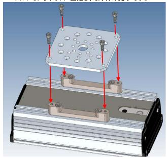
※M6六角穴付ボルトで締付する際の締付トルクは10.8N・m を推奨します。
