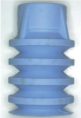
図、黒いシミが発生したパッド
